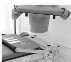
05 Возьмитесь за маленькую смягчающую накладку, приподнимите её, поверните на 180 градусов и установите на место.
